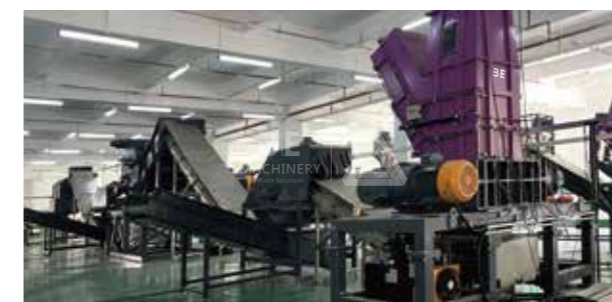
金属包装容器破碎处理线 Waste metal recycling line 4000kg/h
